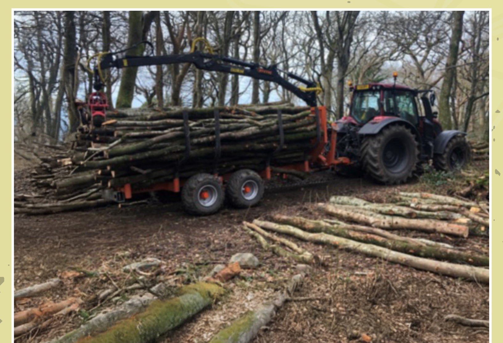
Figurau 3 a 4. Echdynnu pren o ochr y trac a wnaed gyda cheffylau gan fod diddordeb ecolegol uchel ar y safle yn ffafrio dull effaith isel, cyn echdynnu gan ddefnyddio tractor a threilar ymlaen i'r ardal pentryru.
